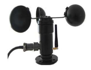
SZ5385 工业型风速传感器为 ZIGBEE 无线式传感器,是一种专门用以监测风速 的检测仪表。仪器能够连续监测风速并远程显示,同时将风速转换成 MODBUS-RTU 标准 ZIGBEE 无线电信号传输给关联设备。
